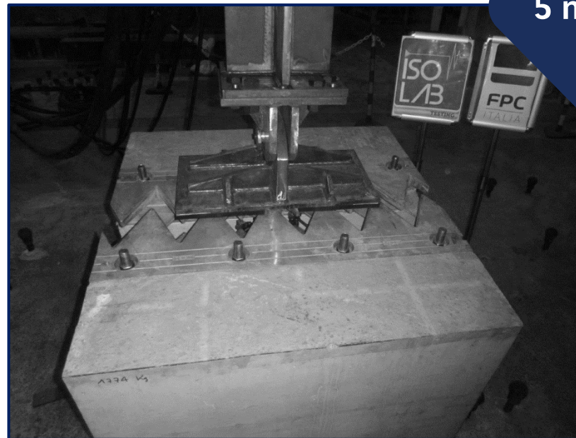
Giunto WD - Prova a fatica
