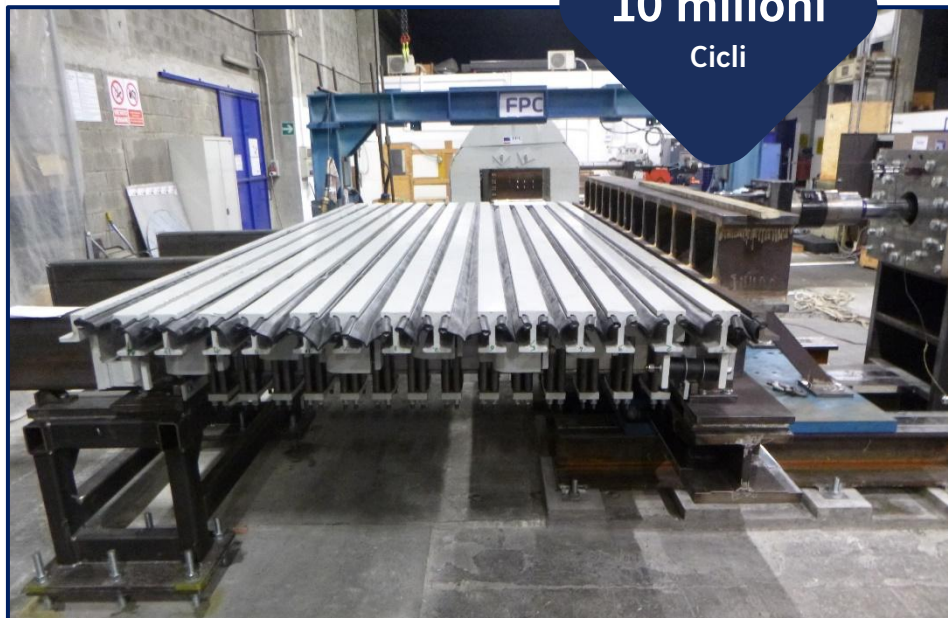
LW 200 (Giunto modulare) - Qualifica AASHTO Fatica & Prova di carico
